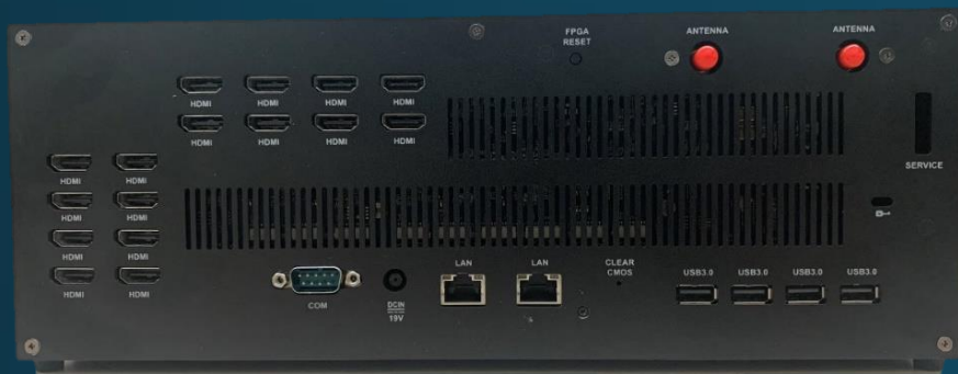
GeniBox-Pro 16+1 后视图,可支持FHD@60~120Hz x16 4x4 或2x8 电视墙拼接
