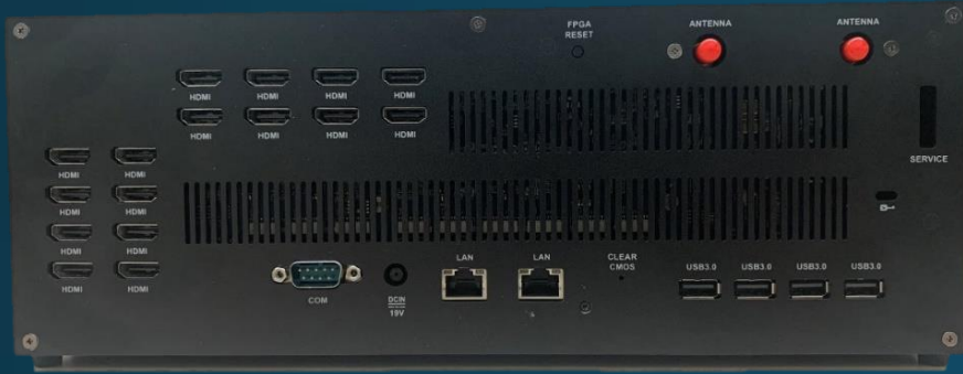
GeniBox-Pro 4K/8K 8+1 后视图,可支持4K@50Hz x8 4K 2x4/4x2 或 8K 1x2/2x1 电视墙拼接
