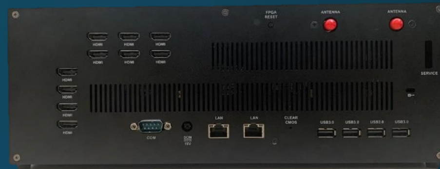
GeniBox-Pro 9/12+1 后视图,可支持FHD@60~120Hz x9 或12 4x3 或 3x3 电视墙拼接
